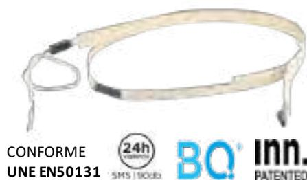
La membrana marco BQ® **detecta anticipadamente el apalancamiento sobre una puerta** o ventana y lo comunica de inmediato al sistema de alarma con el ladrón en el exterior de la vivienda, ya sea por presión sobre los pulsadores de la membrana o por puente o corte de las pistas electrónicas.
