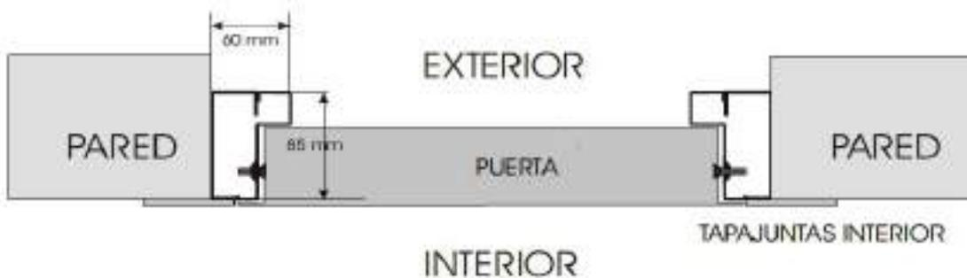
Dimensiones del Pre-marco para obra de acero de 8,5cms. con el bastidor de la puerta
