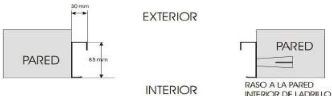
Vista y dimensiones del Pre-marco para obra de acero de 8,5cms. con el bastidor y hoja de la puerta
